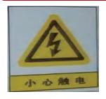
该标识表示:带电的接线端或零部件有高压的危险,维修机器前必须关闭电源。有一些零部件带有220 V或更高电压,如果接触可能有死亡的危险。
