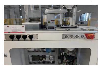
视觉软件打开完成后,按启动按钮运行机台。
